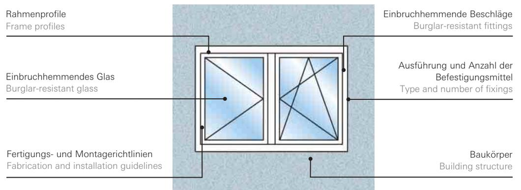
Bei der Schließanlage eines Objekts erhöhen Sicherheitsprofilzylinder, Magnetschalter, elektrische Mehrfachverschlüsse an Türen, abschließbare Fenstergriffe und der verdeckt liegende Sicherheitsbeschlag Schüco AvanTec an Fenstern und Fenstertüren die passive Sicherheit bis zur Widerstandsklasse RC3 (WK3).
